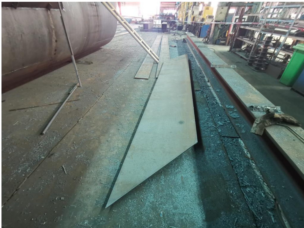
图五 肇事风口板（光滑面）
