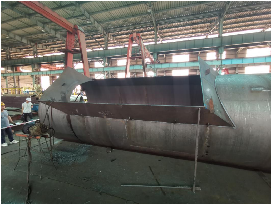
图四 进气口风口板的组装状态
